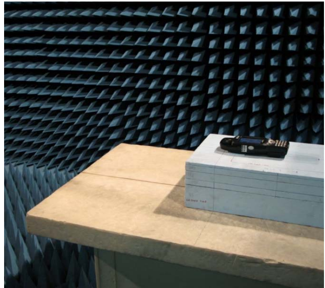
Bild 1: Messung der Sendeleistung und der Richtwirkung eines Handheld-Readers in der Anti-Echo Kammer des EECC
